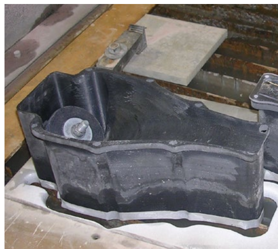
Das NASCAR-Team von Joe Gibbs Racing nutzt die FDM-Technologie zur Fertigung von Vorrichtungen, die teilweise über zwei Jahre im Einsatz sind und die Durchlaufzeit und Kosten durchschnittlich um 70 % gesenkt haben.
